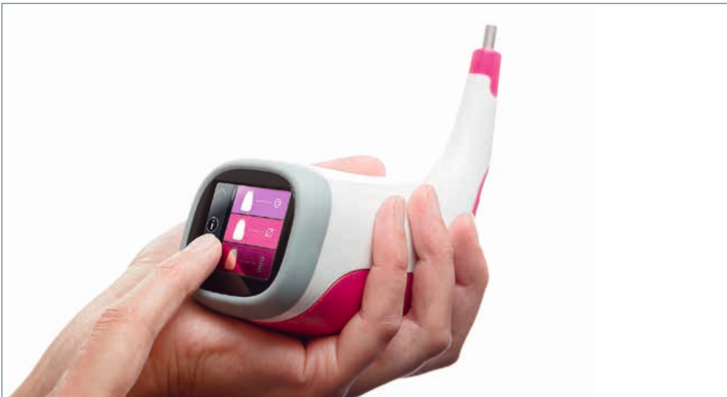
Abb. 2: Auf dem Touch-Display wird eingestellt, ob die Zahngrundfarbe oder Farbverläufe zu messen sind.
