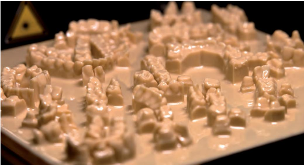
Hier „steigen“ mehrere SLA-Modelle langsam aus einem See von Acrylatkunststoff empor. In der Software wurden die Sägeschnitte bereits angelegt, so dass die Modelle fertig sind, sobald sie ausgehärtet sind.
