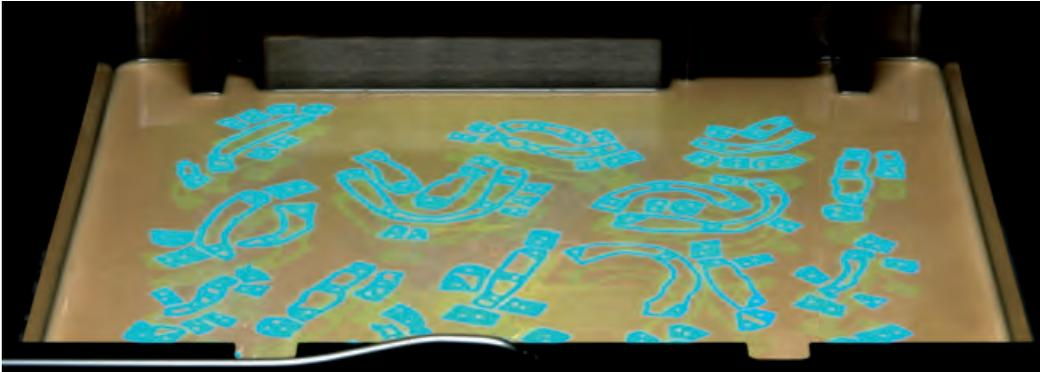
Per Laserstrahl werden die Modelle in einem additiven Verfahren aus flüssigem Kunstharz polymerisiert.
