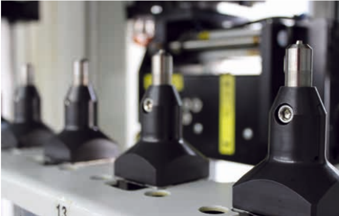
Abb. 3: Ein an der Fräsmaschine angeschlossener Wechselroboter fasst bis zu 120 Titanrohlinge
