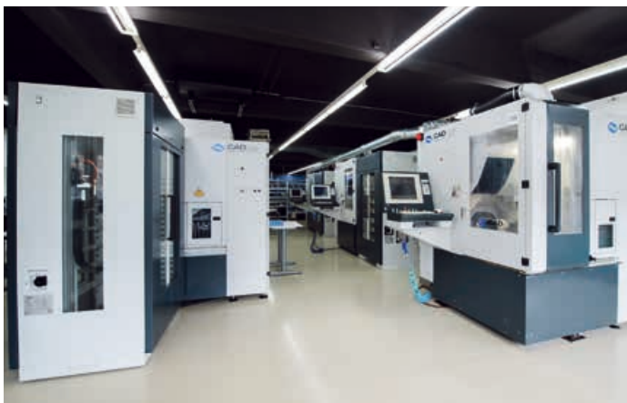
Abb. 4: Der HSC-Maschinenpark mit Werkzeugvermessung. Bruch- und Verschleißkontrolle gewährleistet auch über Nacht eine autarke Produktion
