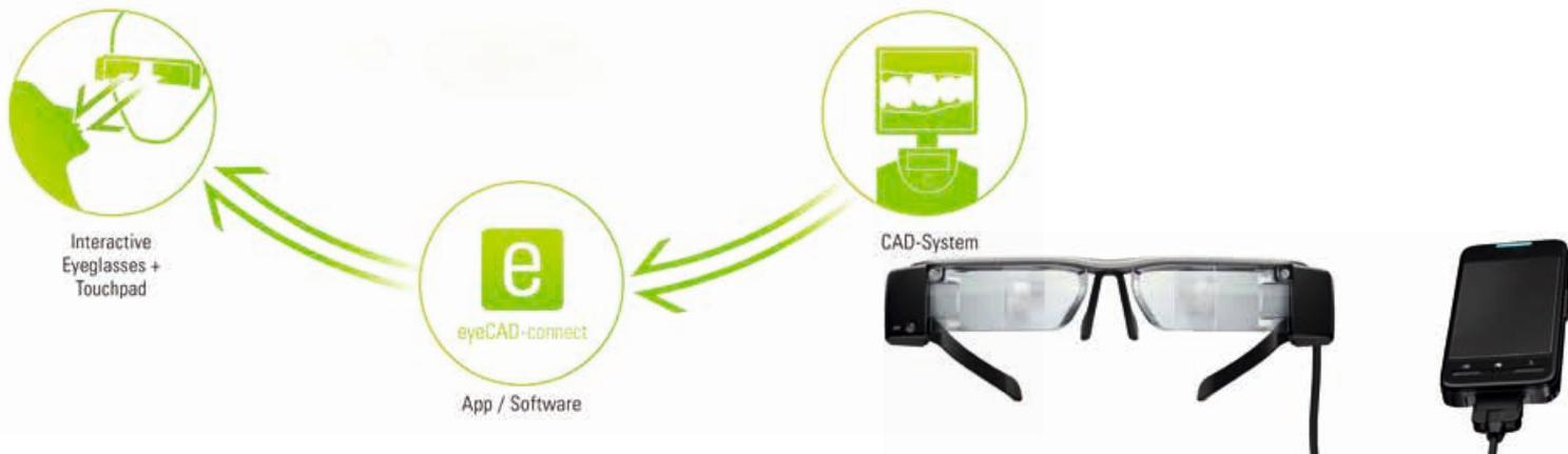
Abb. 11a/b: eyeCAD-connect® System: Datenbrille und Software sind kabellos über WiFi mit dem Scanner verbunden. Das Set wird vollkonfiguriert geliefert
