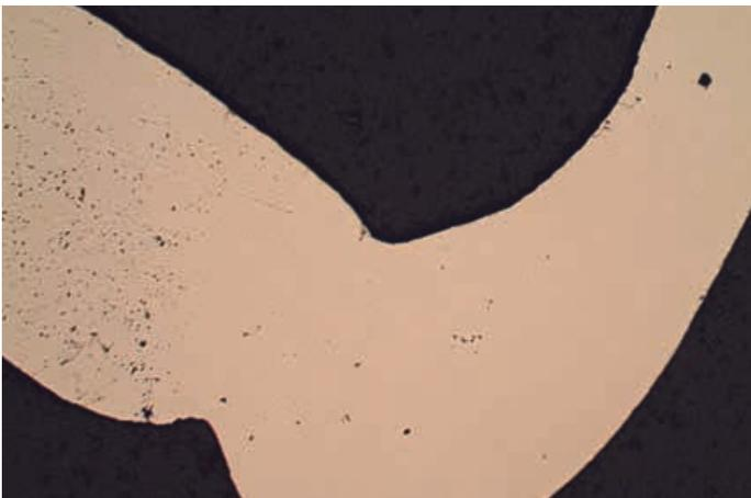
Abb. 02: Gefügestruktur von gegossenen Objekten im Querschnitt unter dem Mikroskop betrachtet
