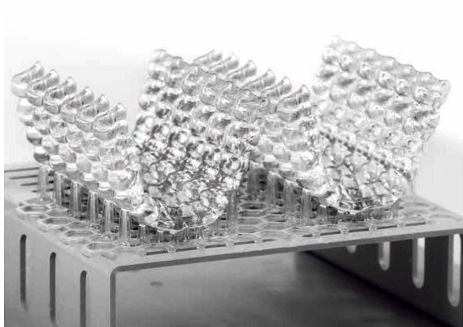
Abb. 2: Additive Verfahren zeichnen sich durch eine hohe Produktivität aus – in einem Druckprozess können viele Bauteile gleichzeitig gefertigt werden
