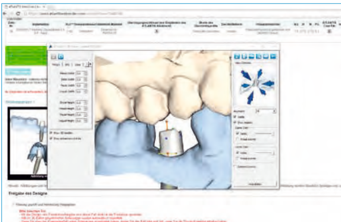
Abb. 11 und 12: Abutmentherstellung mit Dentsply (Atlantis): Konstruktion im Labor, Modell- und Abutmentfertigung bei Atlantis. Rechts Modell und Abutment mit Einsetzschlüssel, wie es vom Originalanbieter ins Labor zurückkommt.
