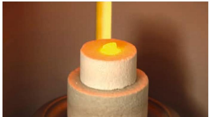
Abb. 5: Das Sintern der Krone im CEREC Speedfire-Ofen dauert nur 15 Minuten.
