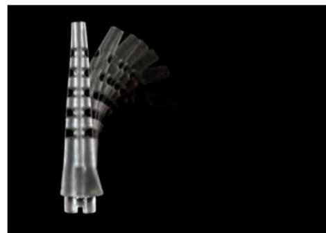
Abb. 42: Das Material FotoMed LED.flex 70 zur Herstellung von flexiblen Objekten.
