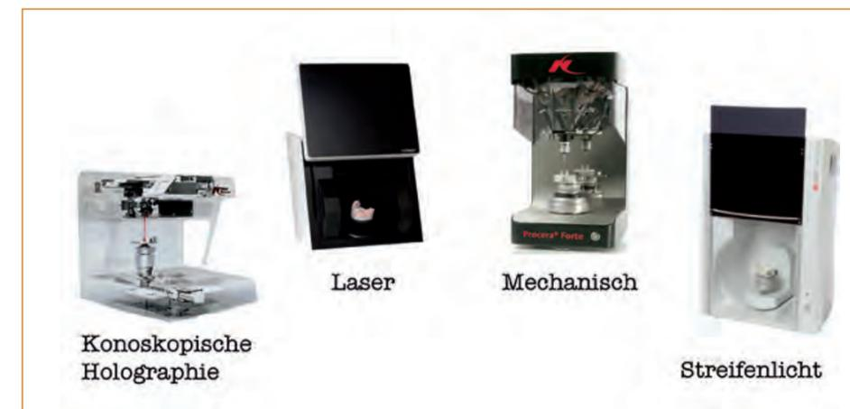
Abb. 3: Überblick der unterschiedlichen Scannertechnologien.
