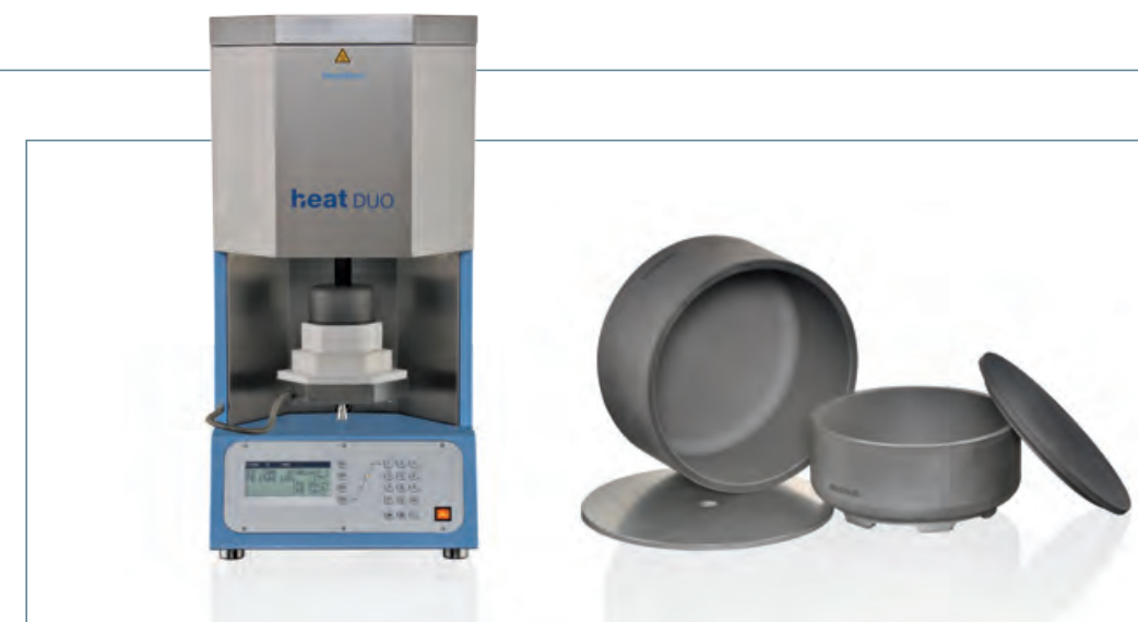
Abb. 10: Der Sinterofen (links): Entscheidend ist die Glocke (rechts), die kontinuierlich während des gesamten Prozesses mit Argon-Schutzgas geflutet wird. – Foto: Noll
