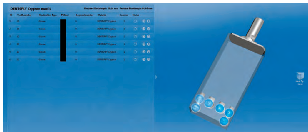
Abb. 6: Stack-Verfahren: links die Anordnung der Zähne, rechts die vollautomatische Platzierung der sechs Kronen im Sintermetall-Block – für eine optimale Materialnutzung. – Foto: Noll
