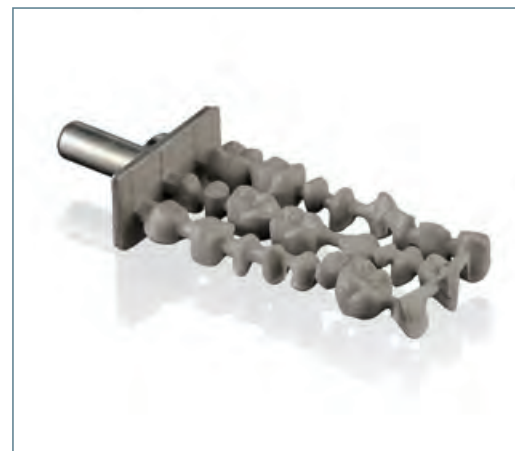
Abb. 15 und 16: Wirtschaftliche Herstellung im Labor: Der größte Crypton-Rohling fasst über 20 Zahneinheiten – auch dank der intelligenten Software. – Foto: DeguDent Nach dem Nassschleif-Prozess können die Objekte herausgetrennt und anschließend versäubert werden. – Foto: DeguDent
