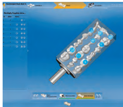
Abb. 15 und 16: Wirtschaftliche Herstellung im Labor: Der größte Crypton-Rohling fasst über 20 Zahneinheiten – auch dank der intelligenten Software. – Foto: DeguDent Nach dem Nassschleif-Prozess können die Objekte herausgetrennt und anschließend versäubert werden. – Foto: DeguDent
