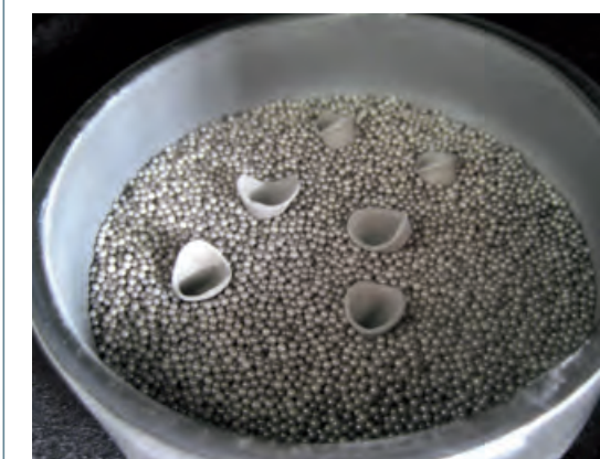
Abb. 11: Die Kappen nach dem Sintern im Sinterbad. – Foto: Noll
