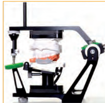
Positionierung des PlanePositioner im physischen Artikulator PSI und Fixierung der Modelle mit Gips
