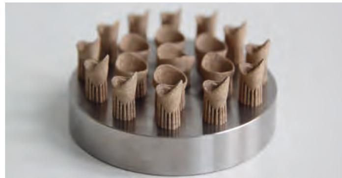
Abb. 5: Dentale Versuchsobjekte zur Materialqualifizierung aus einer hochgoldhaltigen Legierung.
