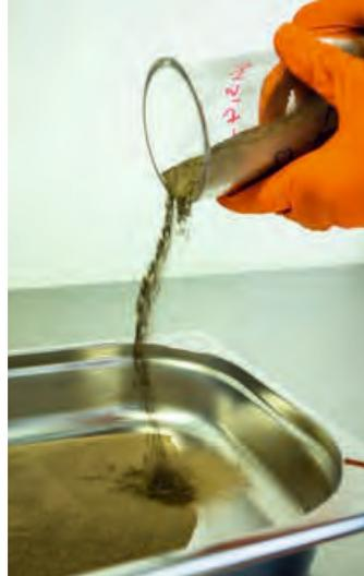
Abb. 1 und 2: Mit der Pulververdünsungsanlage bei C.Hafner werden spezielle Pulver aus Edelmetalllegierungen hergestellt. Nicht nur für die Schmuckindustrie, sondern auch für den Einsatz in der Kronen- und Brückentechnik sowie bei der Hybridfertigung von Sekundär-Teleskopen.
