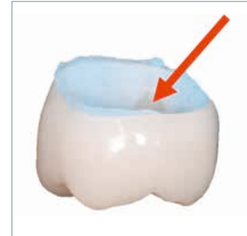
Abb. 5: Exemplarische Darstellung des herkömmlichen Fit-Test zur Kontrolle der Passgenauigkeit in der Zahnarztpraxis am Patienten (roter Pfeil markiert ausgerissenes Silikon aufgrund zu geringem Zementspalt).
