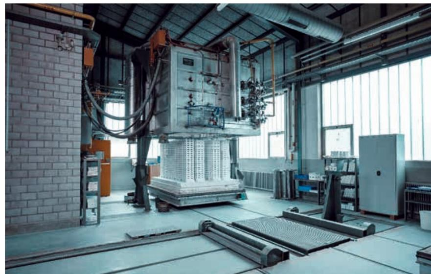
Abb. 5a und b: Der 4 Kubikmeter-Haubenofen für 1.750 °C, installiert in den Jahren 1979 / 80, ist bis heute im Dauereinsatz.
