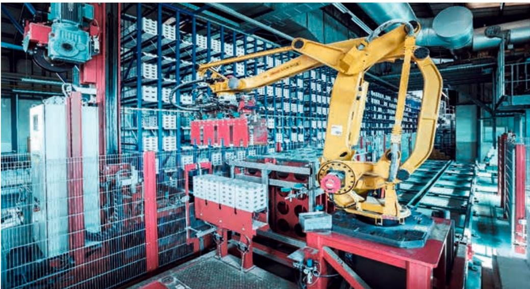
Abb. 2: Laderoboter und vollautomatisiertes Hochregallager für eine Vielzahl von Produkten.
