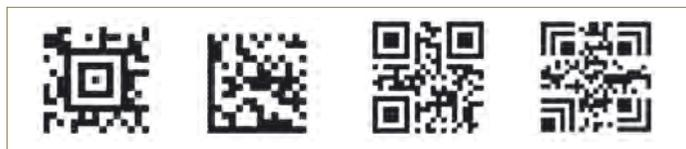
Abb. 2: 2D-Codes: Atztek Code (l.), DataMatrix (2. v.l.), QR-Code (3. v.l.), HanXin-Code (r.); für UDI sind DataMatrix und QR gebräuchlich (Quelle: Literatur 5)
