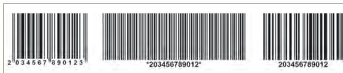
Abb. 1: Lineare Barcodes: EAN13 (l.), Code 39 (m.), Code 128 (r.) (Quelle: Literatur 5)
