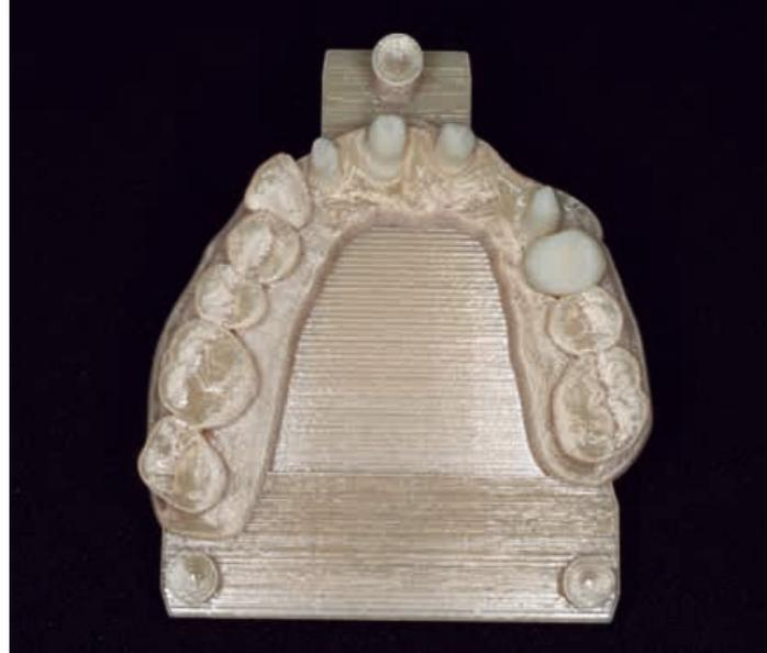
Abb. 3: Gedrucktes 3D-Modell nach der Abformung.
