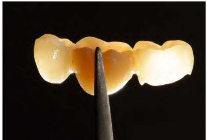
Abb. 7: Zirkonoxid der vierten Generation mit 45%iger Lichtdurchlässigkeit.
