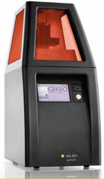
Das sogenannte DLP-Verfahren (Digital Light Projection) macht den cara Print 4.0 schneller, ökonomischer und präziser als Geräte mit SLA-Technologie. Auch im Vergleich mit anderen DLP-Systemen überzeugt der Drucker mit seiner Schnelligkeit.
