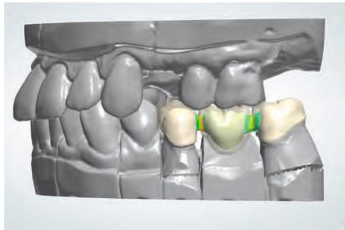
Abb. 57: Prüfen der Stabilität und Materialdicke in den Verbinderbereichen
