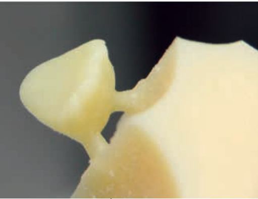
Abb. 12: Die aus einem Wachsrohling gefräste Gerüstkrone
