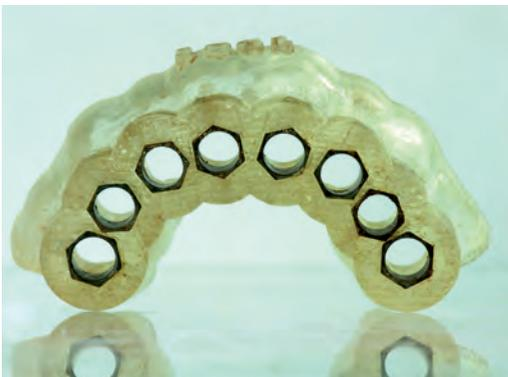
Abb. 30: SIMPLANT SAFE Guide, die knochengetragene Bohrschablone nach der stereolithographischen Herstellung und dem Einsetzen der Slives (Bohrhülsen).
