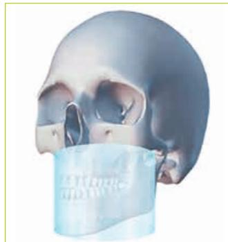
Abb. 2c: Fields of View beim OP300 Maxio: 8 x Ø 8 cm für die Abbildung beider Zahnbögen und Anteilen der Kieferhöhlen
