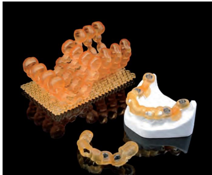
3D-Druck Material für die Herstellung von Bohrschablonen (SHERAprint - SHERA)
