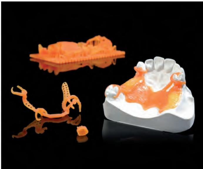
Ausbrennfähiges 3D-Druck Material für die Herstellung von Modellgussgerüsten oder anderen filigranen Arbeiten (SHERAprint - SHERA)
